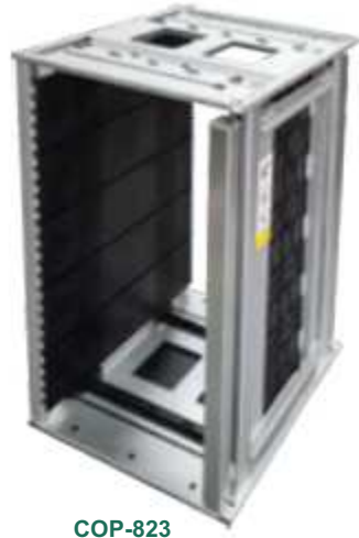
COP-823 Dimensiones: 350X320X563mm Capacidad:50pcs Temperatura Max: 85/125/180 °C Anchos:350 x (50-250) mm
